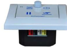
Im Unterteil des Gerätes befinden sich die farbigen WAGO Steckklemmen, sie ermöglichen einen Mehrfachanschluss. An den unteren Anschlüssen (rt, sw, ws, ge) wird die Betriebsspannung und der Modbus (entfällt bei Funkversion) angeschlossen. Beim GreenVent-System mit der Funkversion ist nur die Betriebsspannung anzuschließen (rot und schwarz)
