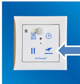
Die Urlaubstaste halbiert die Lüftungszeit bei längerer Abwesenheit. Somit wird unnötiges Lüften vermieden. Die Sensoren sind auch hier jederzeit aktiv, sodass keine langanhaltende Feuchtigkeit entstehen kann bzw. diese umgehend abgeführt wird. Der Urlaubsmodus ist für max. 14 Tage begrenzt und schaltet danach selbstständig wieder in den Automatikbetrieb.
