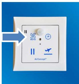
Im Automatikbetrieb ist der Lüftungszyklus aktiviert und alle vorhandenen Sensoren sind aktiv. Einmal pro Stunde öffnet das Lüftungsventil für eine festgelegte Zeitdauer. Somit ist zu jeder Zeit gesichert, dass keine andauernde Feuchte in den Räumen vorhanden ist. Sobald sich z.B. die relative Feuchte über den festgelegten Wert ändert, öffnet das GAV-Lüftungsventil und wenn angeschlossen die AirTronic® Fensterlüfter.
