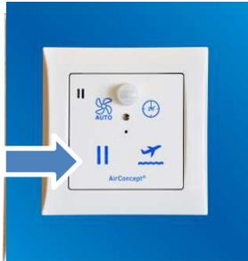
Die Pausenfunktion kann den subjektiven „Frier-Effekt“ verhindern. Dieses Empfinden tritt auf, wenn Sie mit nasser Haut in einem kleinen Raum stehen, aus dem gerade eine hohe Luftmenge abgeführt wird, weil der Feuchtesensor ausgelöst hat. Wenn Sie diese Taste betätigen, wird der Feuchtesensor überbrückt und das Lüftungsventil bleibt für 30 min geschlossen. Anschließend schaltet das AirConcept® GreenVent - System selbsttätig wieder in den Automatik-Betrieb.
